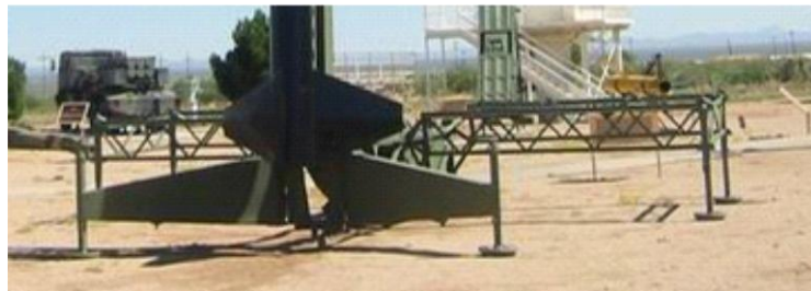
Rampe mobile Ajax déployée. (Le missile est levé, seul est visible la base du booster).
